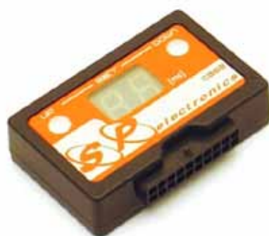
Ebox : permet de gérer les réglages de Cut Off (coupure à l'injection).
